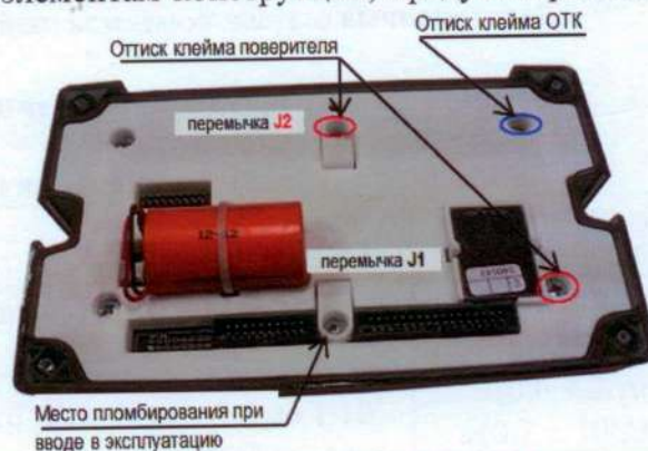
Рисунок 2 – Места пломбирования вычислителя
